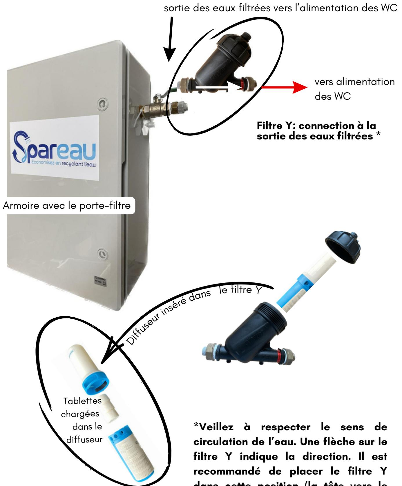
**\*Veillez à respecter le sens de circulation de l'eau. Une flèche sur le filtre Y indique la direction. Il est recommandé de placer le filtre Y dans cette position (la tête vers le haut)**
